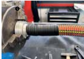
① Metallknickschutzspirale über den Schlauch ziehen, dabei vorsichtig die Spirale leicht aufdrehen ② Knaggenteil, Sperring und 2 Schrumpfschläuche über den Schlauch ziehen ③ 1,8 mm Draht mit 2 x 6 Windungen wickeln, mit einer Verbindungskette zwischen den 2 Einbindefeldern ④ Schrumpfschläuche auf die Metallknickschutzspirale am Knaggenteil vorne und am Ende der Spirale aufschieben ⑤ mit einer Heißluftpistole den Schrumpfschlauch langsam erhitzen ⑥ Nun im Endbereich der Metallknickschutzspirale einen Schrumpfschlauch aufsetzen und auch mit der Heißluftpistole langsam erhitzen.
