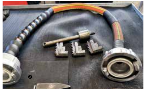
① Schrumpfschläuche müssen am Stutzen vorne an der Metallknickschutzspirale und zur Hälfte über das Ende der Metallknickschutzspirale verschmolzen sein ② Fertig eingebundener GH TEXFLEX X-TREME.
