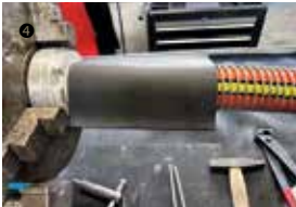
① Metallknickschutzspirale über den Schlauch ziehen, dabei vorsichtig die Spirale leicht aufdrehen ② Knaggenteil, Sperring und 2 Schrumpfschläuche über den Schlauch ziehen ③ 1,8 mm Draht mit 2 x 6 Windungen wickeln, mit einer Verbindungskette zwischen den 2 Einbindefeldern ④ Schrumpfschläuche auf die Metallknickschutzspirale am Knaggenteil vorne und am Ende der Spirale aufschieben ⑤ mit einer Heißluftpistole den Schrumpfschlauch langsam erhitzen ⑥ Nun im Endbereich der Metallknickschutzspirale einen Schrumpfschlauch aufsetzen und auch mit der Heißluftpistole langsam erhitzen.
