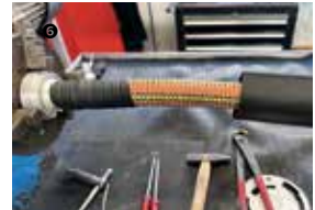
① Metallknickschutzspirale über den Schlauch ziehen, dabei vorsichtig die Spirale leicht aufdrehen ② Knaggenteil, Sperring und 2 Schrumpfschläuche über den Schlauch ziehen ③ 1,8 mm Draht mit 2 x 6 Windungen wickeln, mit einer Verbindungskette zwischen den 2 Einbindefeldern ④ Schrumpfschläuche auf die Metallknickschutzspirale am Knaggenteil vorne und am Ende der Spirale aufschieben ⑤ mit einer Heißluftpistole den Schrumpfschlauch langsam erhitzen ⑥ Nun im Endbereich der Metallknickschutzspirale einen Schrumpfschlauch aufsetzen und auch mit der Heißluftpistole langsam erhitzen.
