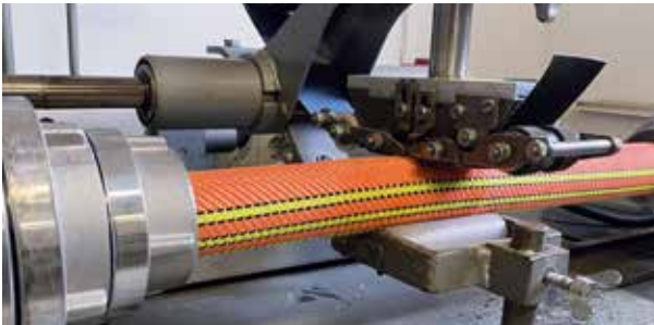
Links: Abriebtest Oben: Schlauch nach Abrieb
