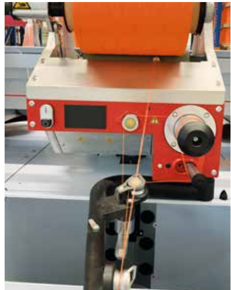
Bild rechts: Zwirnen des Vielfachgarnes zu einem Faden
